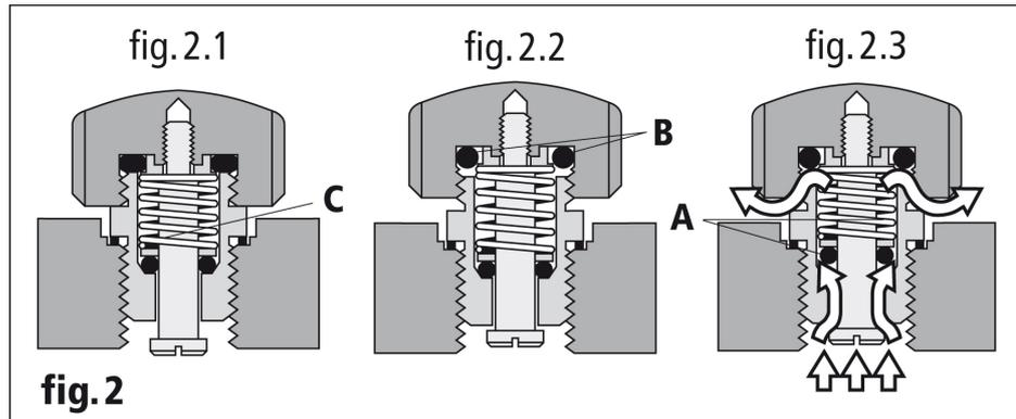
Durante la decompressione occorre svitare la corona della valvola in modo da liberarne il meccanismo (fig. 2.2). A questo punto la valvola è impermeabile dall'esterno verso l'interno. Quando la pressione esterna è inferiore a quella interna entra in azione la valvola spingendo il giunto (A) verso l'esterno, liberando così il gas (fig. 2.3). Quando le due pressioni tornano a equilibrarsi, il giunto (A) riprende il suo posto, spinto dalla molla (C) (fig. 2.2).
