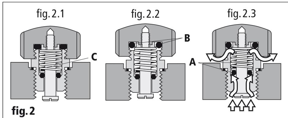
В период декомпрессии отвинтите головку клапана, чтобы освободить его механизм (рис. 2.2). При этом клапан сохраняет водонепроницаемость. По мере того, как внутреннее давление становится больше внешнего, прокладка (A) под давлением смещается, выпуская газ (рис. 2.3). Когда внешнее и внутреннее давления становятся равными, прокладка (A) под действием пружины (C) занимает первоначальное положение (рис. 2.2).
