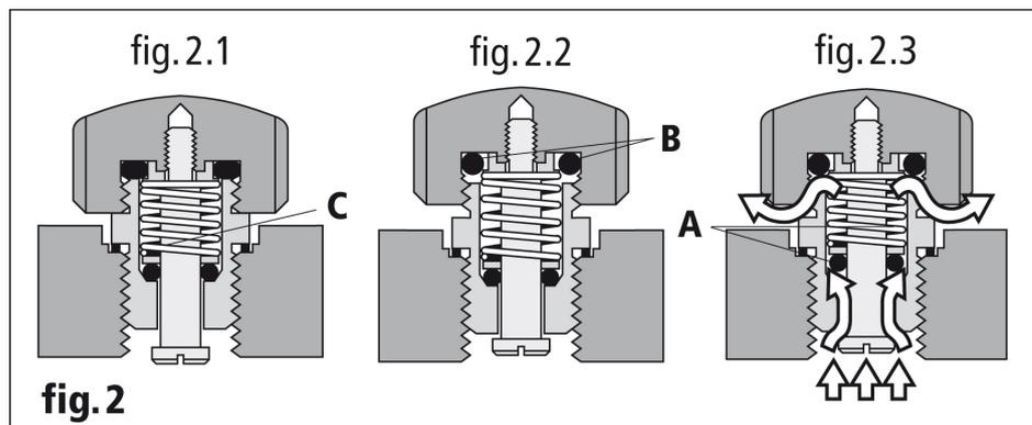
在減壓的階段中，扭開閥門的門圈，使它的機件開放 ( fig. 2.2 )。此時防水性能由內變外，由於內裡壓力比外面的壓力大，在暗室內的墊圈A會被推上，氣體即排出錶外 ( fig. 2.3 )。當內外壓力相等時，墊圈A即被彈簧C推回 ( fig. 2.2 )。
