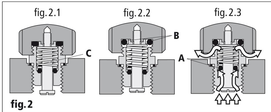
Während der Dekompressionsphase wird die Krone des Ventils aufgeschraubt, damit das Helium entweichen kann (fig. 2.2). Das Ventil ist von außen immer noch wasserdicht. Sobald der innere Druck höher ist als der äußere, wird die Dichtung (A) aus der Halterung gestoßen und das Gas kann entweichen (fig. 2.3). Sobald der Druck ausgeglichen ist, kehrt die Dichtung (A), unterstützt von der Feder (C), in ihre Normalposition zurück (fig. 2.2).
