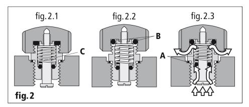
Während der Dekompressionsphase wird die Krone des Ventils aufgeschraubt, damit das Helium entweichen kann (fig. 2.2). Das Ventil ist von außen immer noch wasserdicht. Sobald der innere Druck höher ist als der äußere, wird die Dichtung (A) aus der Halterung gestoßen und das Gas kann entweichen (fig. 2.3). Sobald der Druck ausgeglichen ist, kehrt die Dichtung (A), unterstützt von der Feder (C), in ihre Normalposition zurück (fig. 2.2).
