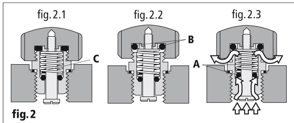
在減壓的階段中，扭開閥門的門圈，使它的機件開放 (fig. 2.2)。此時防水性能由內變外，由於內裡壓力比外面的壓力大，在暗室內的墊圈A會被推上，氣體即排出錶外 (fig. 2.3)。當內外壓力相等時，墊圈A即被彈簧C推回 (fig. 2.2)。
