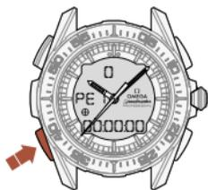
Cuando se muestre la función PE1, PE2 o PE3, entrar en el modo Programación
