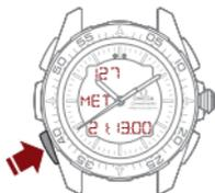
Spostamento delle lancette in posizione di lettura ottimale del display digitale
