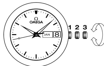
Внимание: при корректировке даты назад в режиме установки точного времени необходимо перевести стрелки обратно к отметке 14 часов для обеспечения смены даты.
